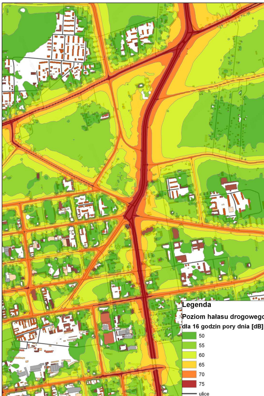
Mapa 5. Mapa akustyczna Łodzi 2012-2017 – Poziom hałasu drogowego dla 16 godzin pory dnia – rejon Ronda Solidarności.
