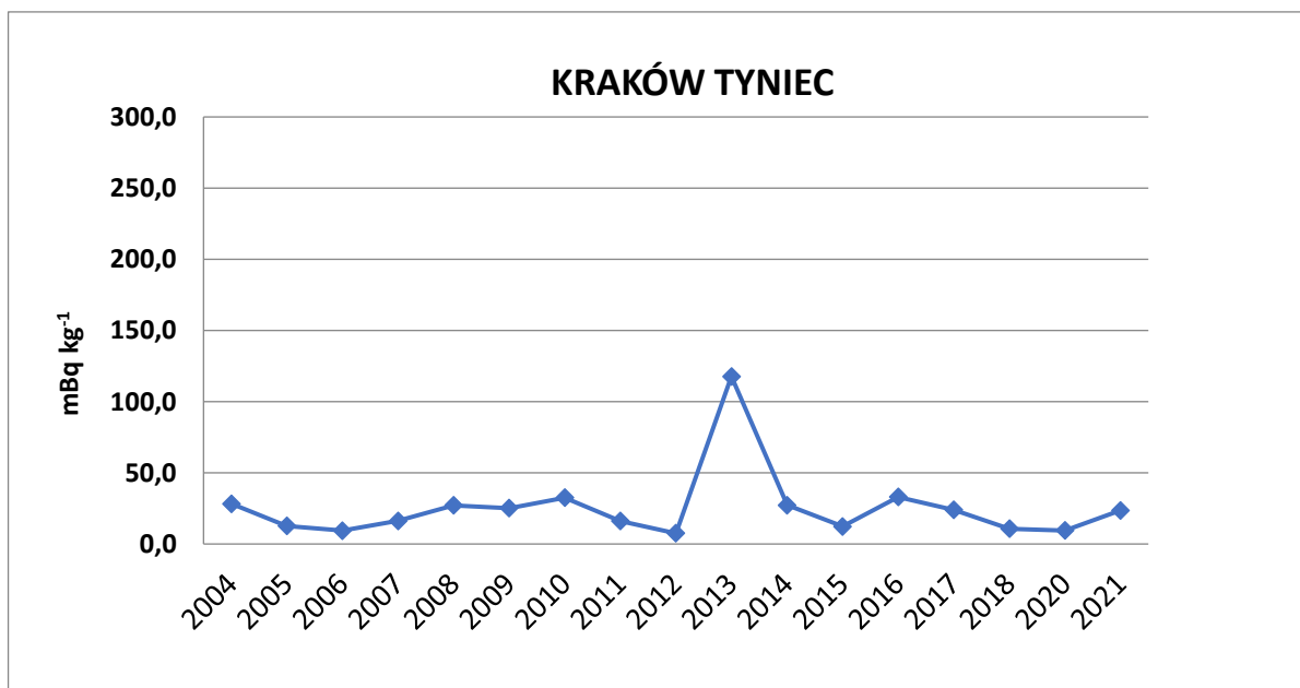
Rys. 29. Zawartość ^{239,240}\text{Pu} w osadach Wisły pobranych w Krakowie w latach 2004-2021
