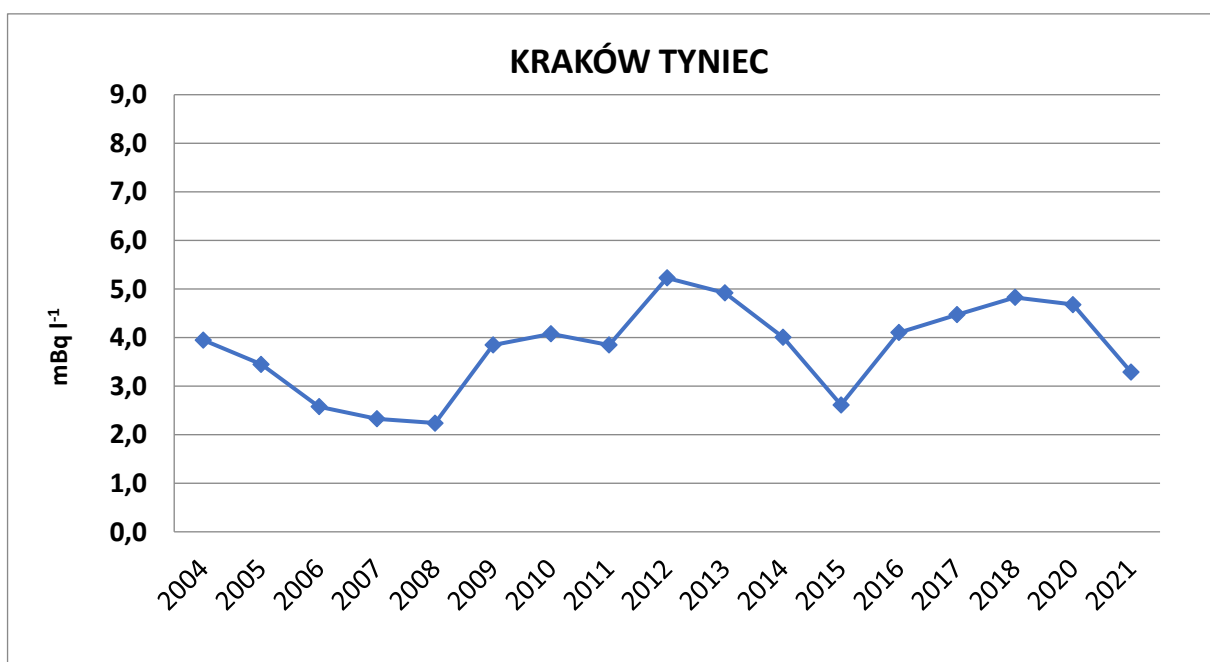
Rys. 8. Zawartość ^{137}\text{Cs} w wodach Wisły pobranej w Krakowie w latach 2004-2021
