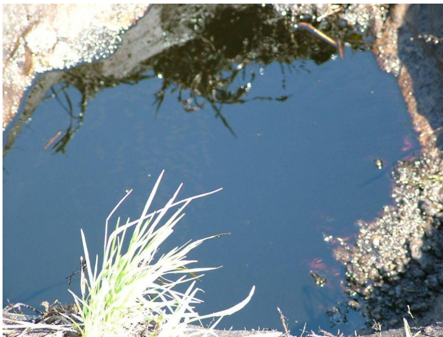
Fot. 6. Warstwa ropy w lokalnym zagłębieniu terenu (miejsce prowadzenia pompowania)
