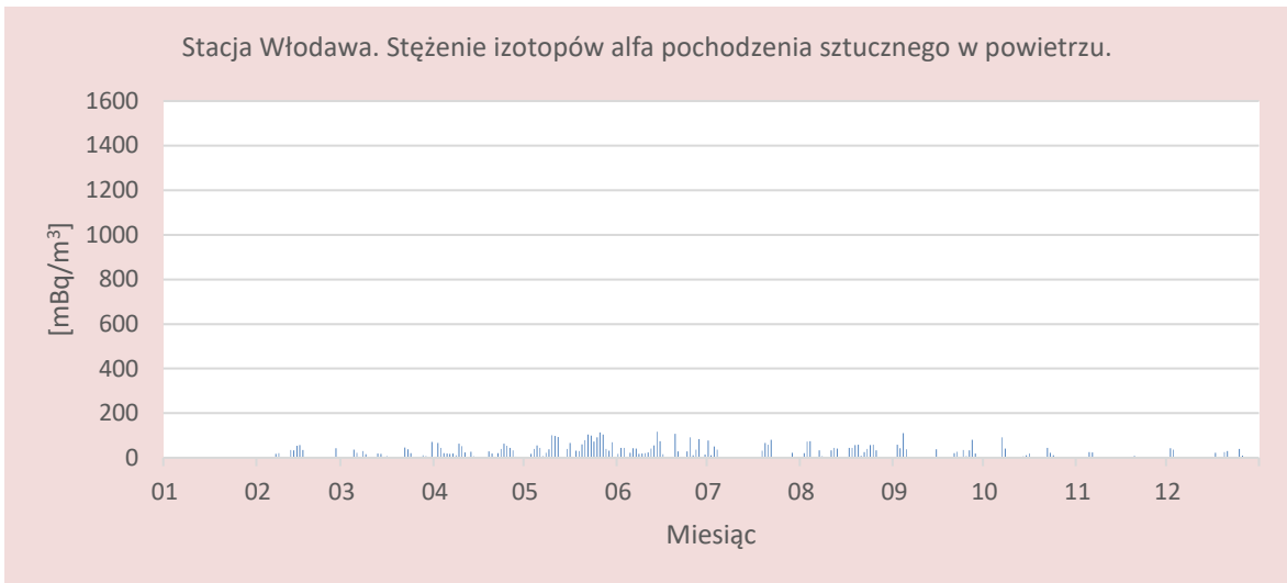
Rys.23. Stężenie promieniotwórcze izotopów alfa pochodzenia sztucznego w aerozolu na stacji Włodawa w 2021 roku
