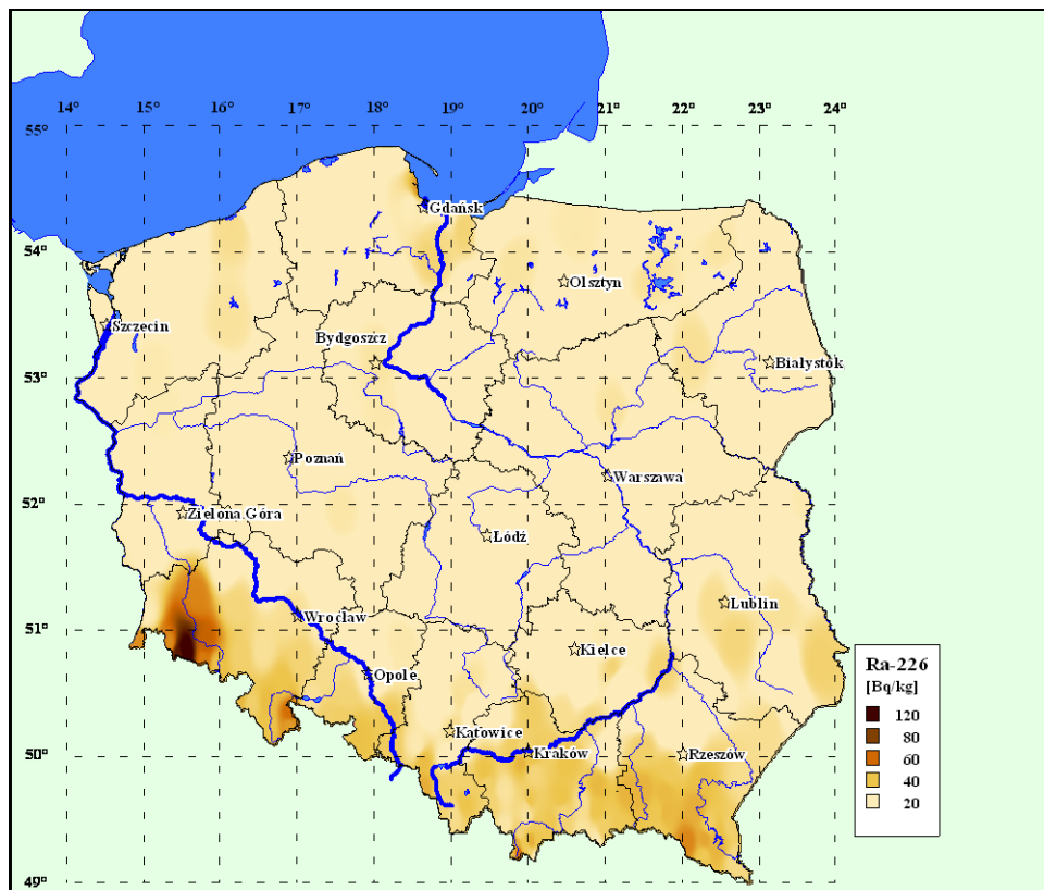
Rys. 14. Mapa rastrowa obrazująca stężenie ^{226}\text{Ra} w Polsce (w Bq/kg) w próbkach gleby pobranej w październiku 2010 roku.
