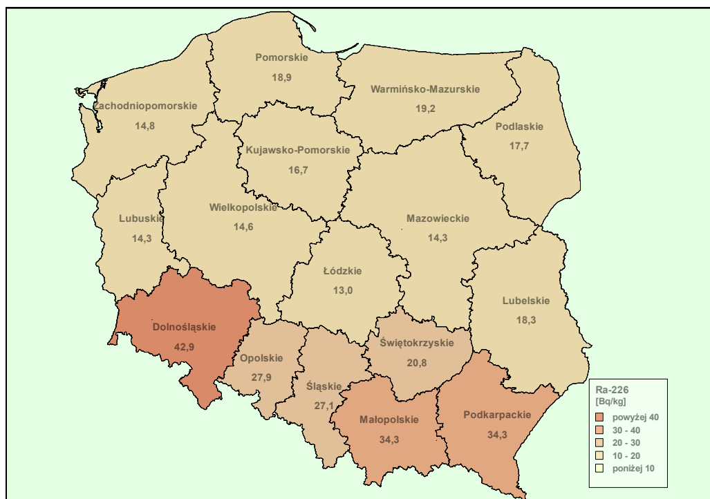
Rys. 20. Rozkład średnich stężeń ^{226}\text{Ra} [Bq/kg] w województwach na obszarze Polski dla gleby pobranej w październiku 2010 roku.
