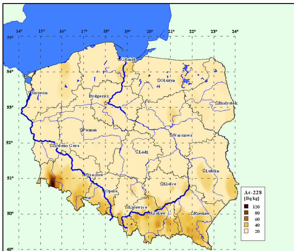
Rys. 15. Mapa rastrowa obrazująca stężenie ^{228}\text{Ac} w Polsce (w Bq/kg) w próbkach gleby pobranej w październiku 2010 roku.
