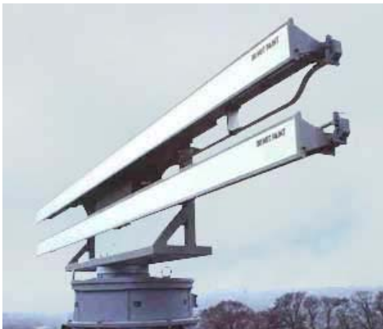
Zdjęcie 6.1 Antena radarowa radaru kontroli płyty lotniska ASC-10 [35].
